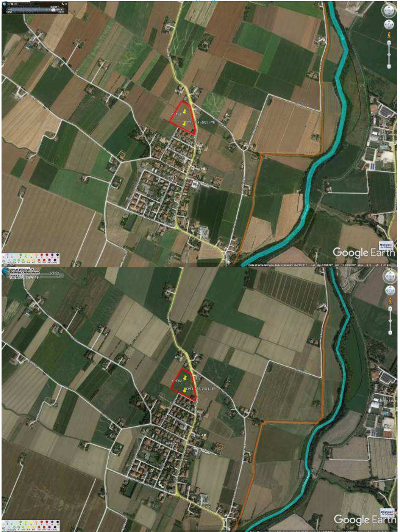
Fig. 1/2: Ubicazione dell'area in esame, su orto- foto aeree a Scala libera. Si è riportato il corso del Reno, i suoi argini artificiali (in arancione) e l'individuazione dei corpi divagativi locali (Ventagli di Rotta/di Esondazione) di cui si dirà in relazione.
